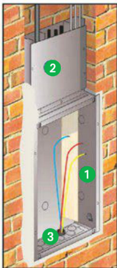
1 Bac d'encastrement acier avec tasseaux bois
